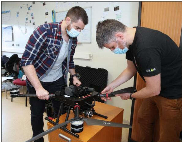
Julien Masseron (à gauche) et Émilien Wilhelm équipent le drone qui sert à mesurer la radioactivité dans l'environnement. Photo L'Alsace/Jean-Marc LOOS
