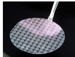
Circuit réalisé par les étudiants dans le cadre du stage d'initiation aux techniques de fabrication des circuits intégrés.
